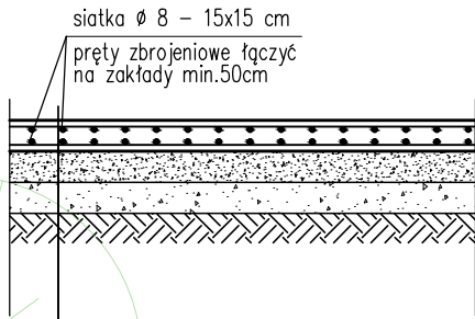
PRZESZKODY SPOSÓB ZBROJENIA 1:20
