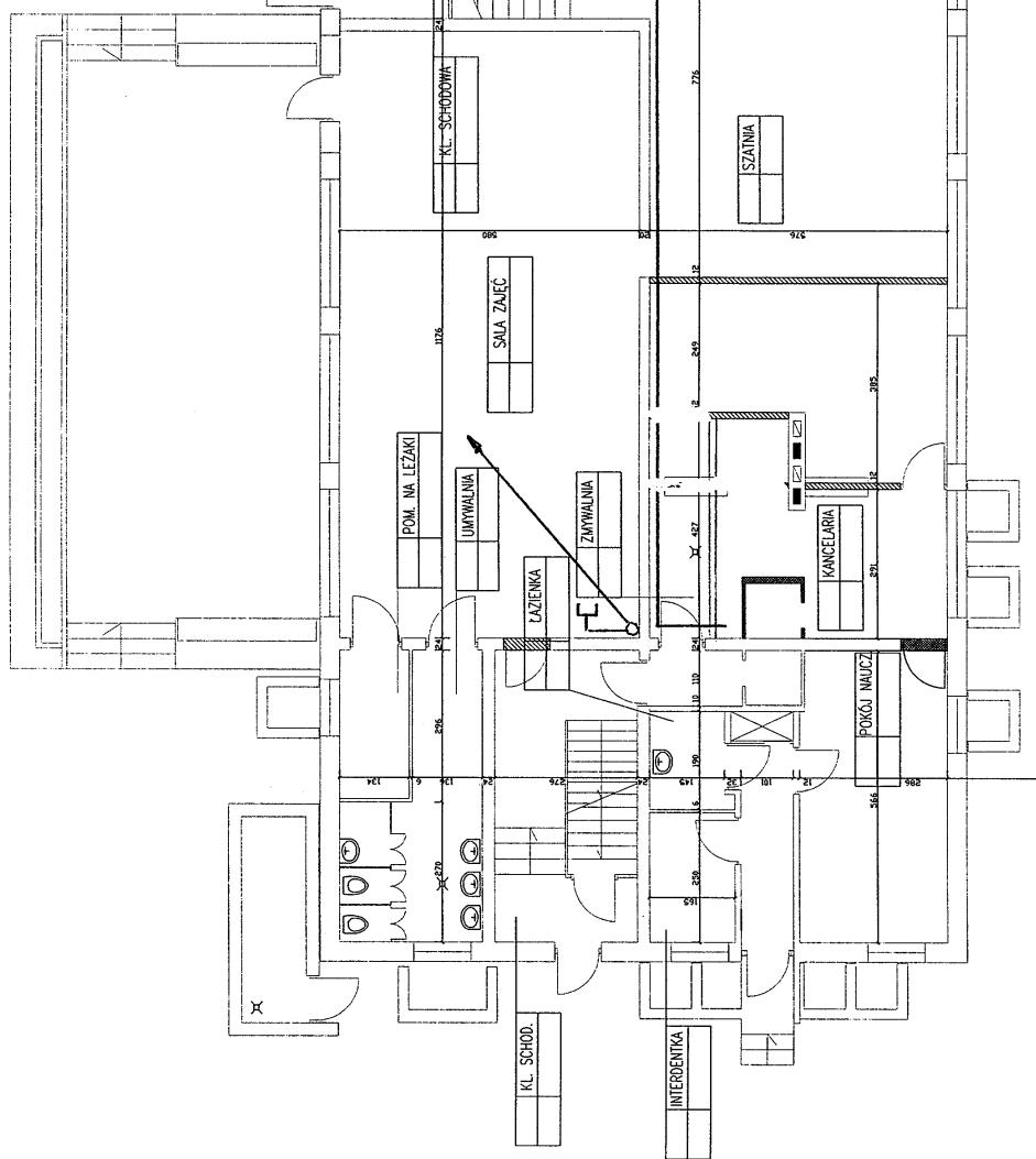
kabel koncentryczny RG 59 [ ] gniazdo RTV
